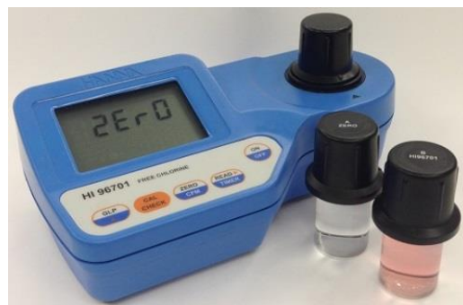
バリデーターは 0ppm と 1.00ppm の標準液がセットになっています。
